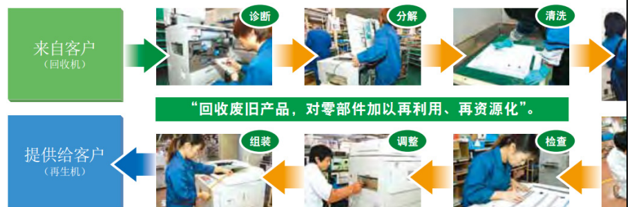
图 3 再生机的制造过程(日本的实例)
